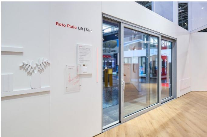
RC-2-fähig wurde dieses Schiebeelement mit dem Hebeschiebebeschlag „Roto Patio Lift | Slim“ für sehr schmale Profile durch den Einsatz des „DesignLocking“-Getriebes und passender Schließstücke plus Anbohrschutz, Aushebelsicherung, abschließbarem Griff und sicherheitsrelevanten Komponenten des Systemgebers. Im Bild ein Schiebeelement im Format 4.000 x 2.548 mm, ausgestattet mit MVS-Kontakten für eine elektronische Verschlussüberwachung.
