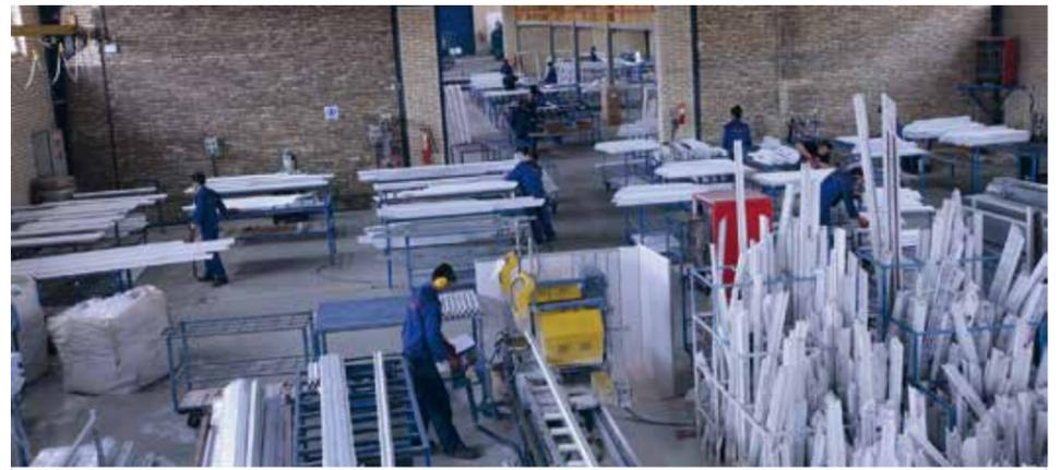
Rund sechzig Mitarbeiterinnen und Mitarbeiter produzieren auf den modernen Fertigungsanlagen von Hooramco vor den Toren von Teheran Fenster und Hauseingangstüren aus Kunststoff, die generell mit einer Doppelverglasung ausgerüstet sind.
