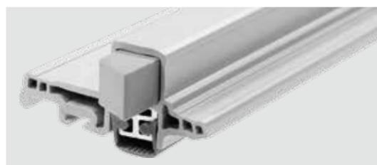
Effektiver Kälte-, Lärm- und Staubsblocker: Die Boden-Türdichtung Roto Eifel Texel überzeugt durch ihren schallabsorbierenden Kunststoffkörper, integrierte Hohlkammern, ein Silikondichtprofil sowie eine vorgelagerte Bürstendichtung im Mittelsteg (im Foto nicht zu sehen).
