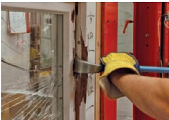
**l:** Kuhfuß im Einsatz: Die Prüfung von einbruchhemmenden Fenstern erstreckt sich u. a. auf die Widerstandsfähigkeit gegen manuelle Einbruchversuche nach EN 1630.
