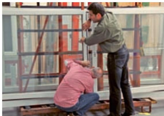
**l:** Das Abdrücken der Glasecke gehört zum Prüfverfahren bei einbruchhemmenden Fenstern und ermittelt die Widerstandsfähigkeit nach EN 1628.
