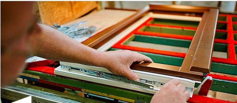
**Drehkipp-Elemente fertigt die Tischlerei Pötschke mit Beschlägen aus dem Programm „Roto NX“. Die optimierte voll verdeckte Bandseite „Roto NX | C“ für Flügelgewichte bis 180 kg übernahm das Unternehmen als eines der ersten in Deutschland.**
