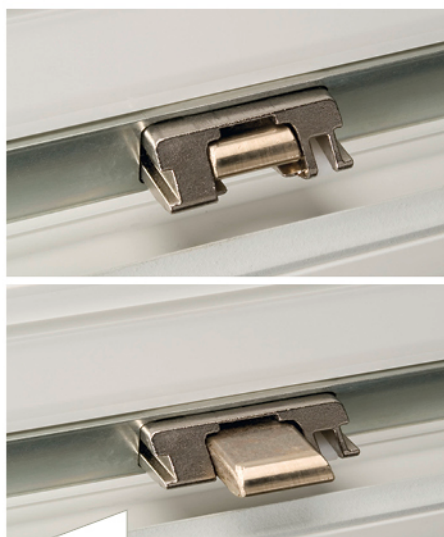
Auch die neue mechanisch-automatische Mehrfachverriegelung „Roto Safe C Tandoe“ wird bei zylinderbetätigten Sievers-Türen eingesetzt. Ihr besonderes Plus: Die serienmäßige Aufnahme für die (im unteren Bild ausgefahrne) Tagesentriegelung. Sie ermöglicht eine werkzeuglose Nachrüstung und vermeidet teure Sonderschlösser.
