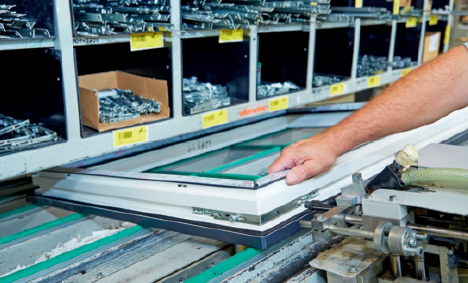
Die Beschlagmontage am Flügelanschlagstisch bei Felina.
