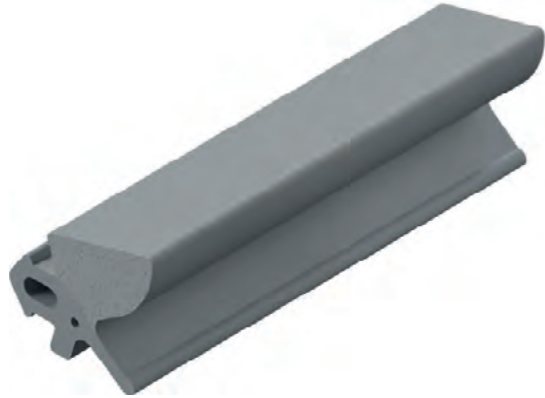
El especialista en perfiles estanqueizantes Deventer ha desarrollado una nueva junta exterior para ventanas de madera-aluminio. Esta sella de forma flexible y fiable la fuga entre el vidrio y la carcasa de aluminio, con aire de tope de hasta 6,5 mm.
