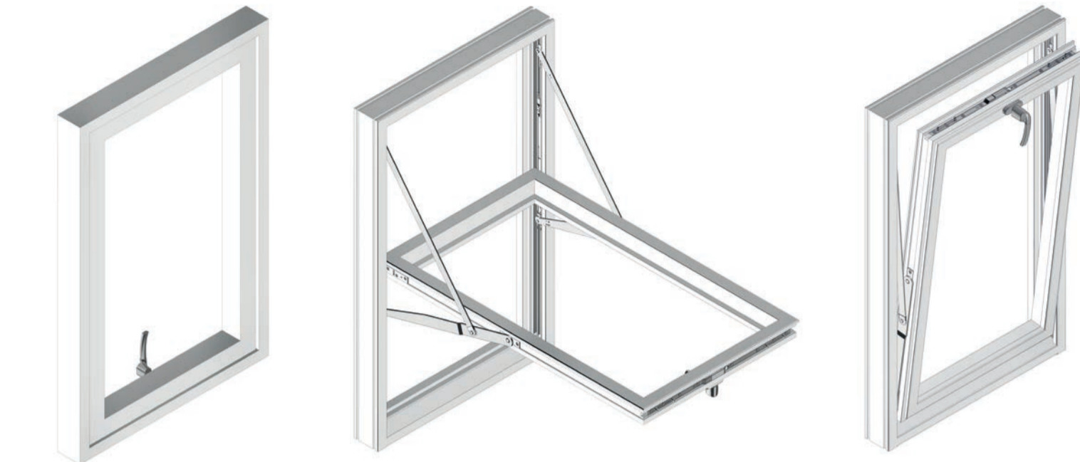
Para limpiar la parte exterior de la hoja, solo hay que girar la manilla, abrir el elemento, empujar la hoja hacia afuera y girarla completamente.
