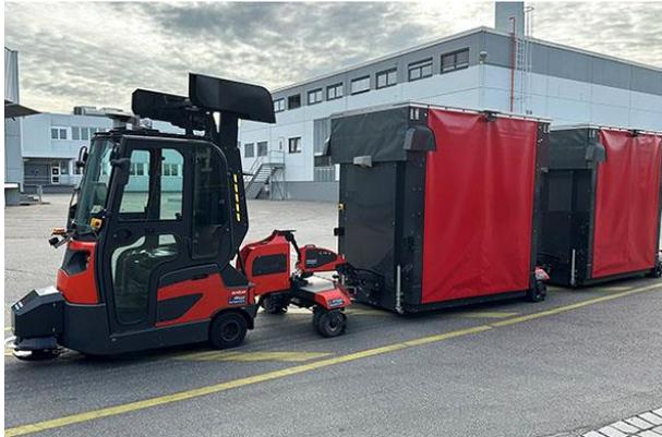
Automatización de la intralogística: además de numerosos sistemas de transporte autónomos en las naves de producción, Roto FTT apuesta en su planta de Leinfelden-Echterdingen por un tren sin conductor en espacios exteriores. De propulsión eléctrica, lleva la producción a la zona de expedición de forma autónoma.
